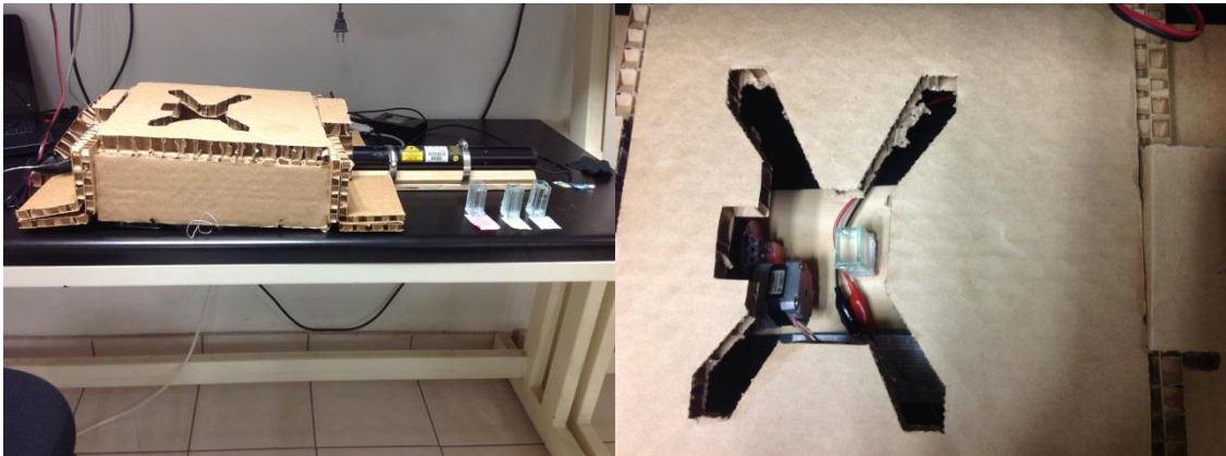
Estructura de cartón para polarímetro
