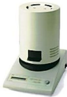
Fig. 2. Moisture Determination Balances, modelo A&D 4714A.
