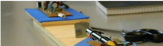
Figura 8. Laser Beam Audio Communicator colocado en las bases.
