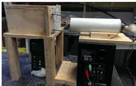
Imagen 4. Prueba de aislamiento acústico realizada a paneles.
