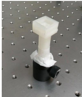
Figura 18. Base creada para dar estabilidad y ubicación más precisa a las muestras
