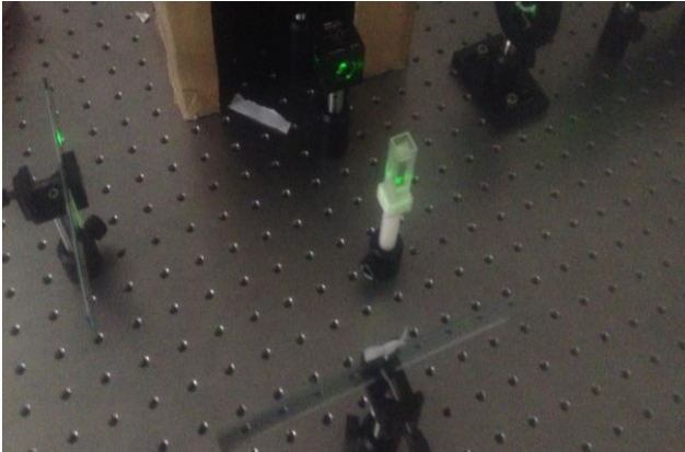
Figura 17. Interferómetro de Michelson construido y utilizado.
