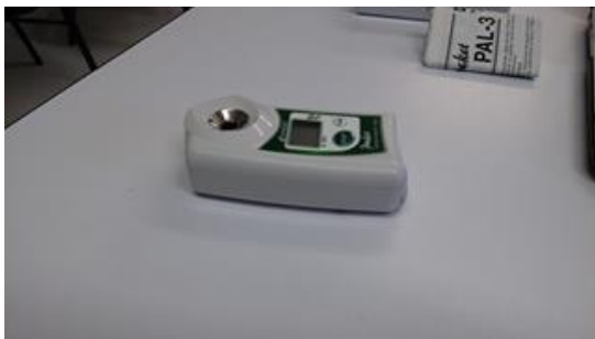
Figura 10. Refractómetro digital empleado en las mediciones del índice de refracción de las muestras.
