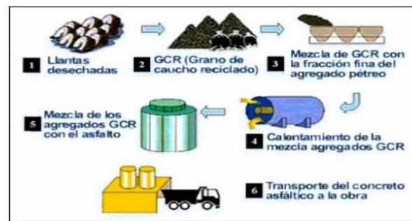
Fig.3.2 Elaboración de mezcla asfáltica modificada por vía seca. [21]
